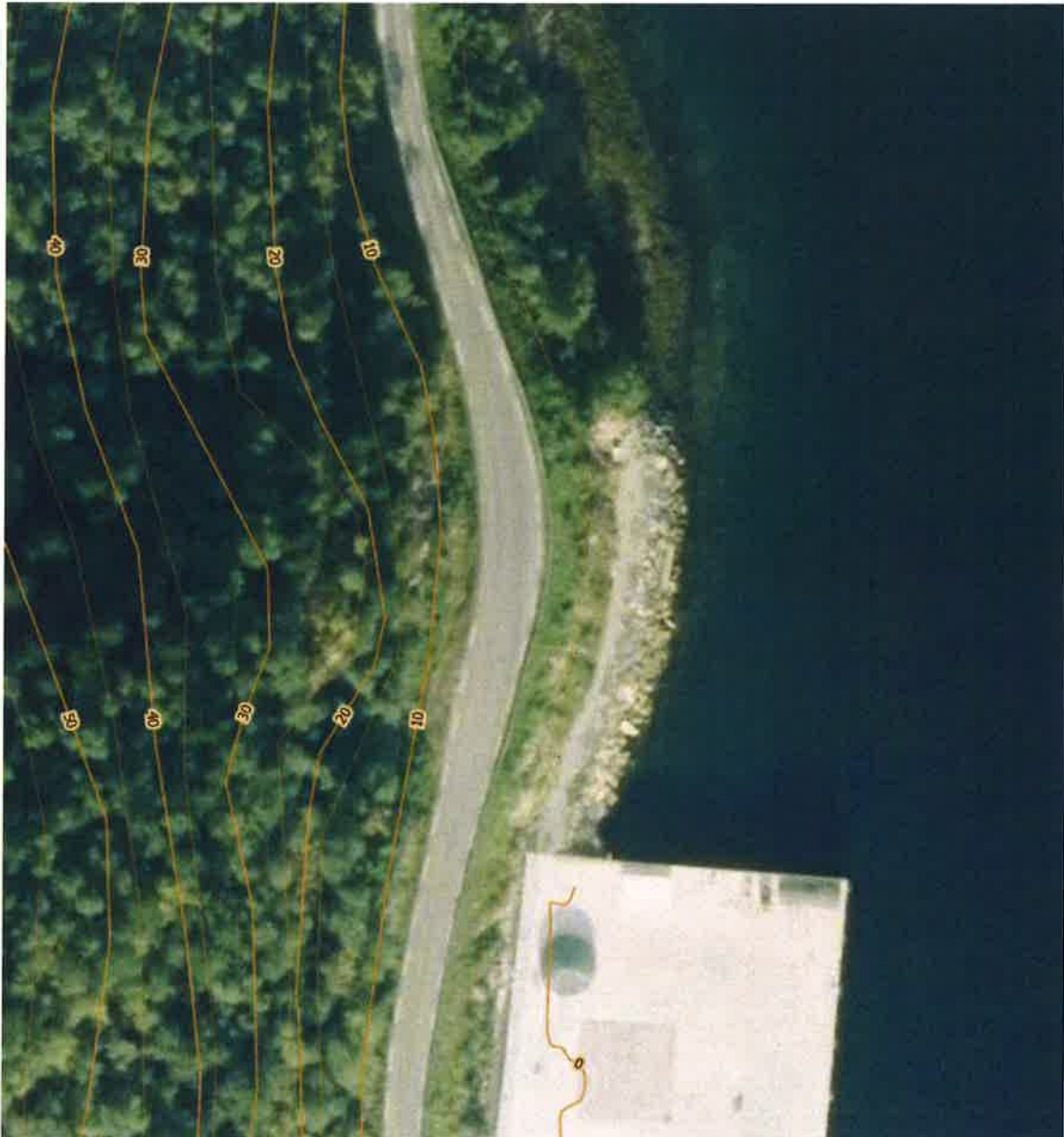
Figur 2-4 Landkotene viser horisontal lengde ca. 10 m fra vegskulder i innersving og til 20-koten.
