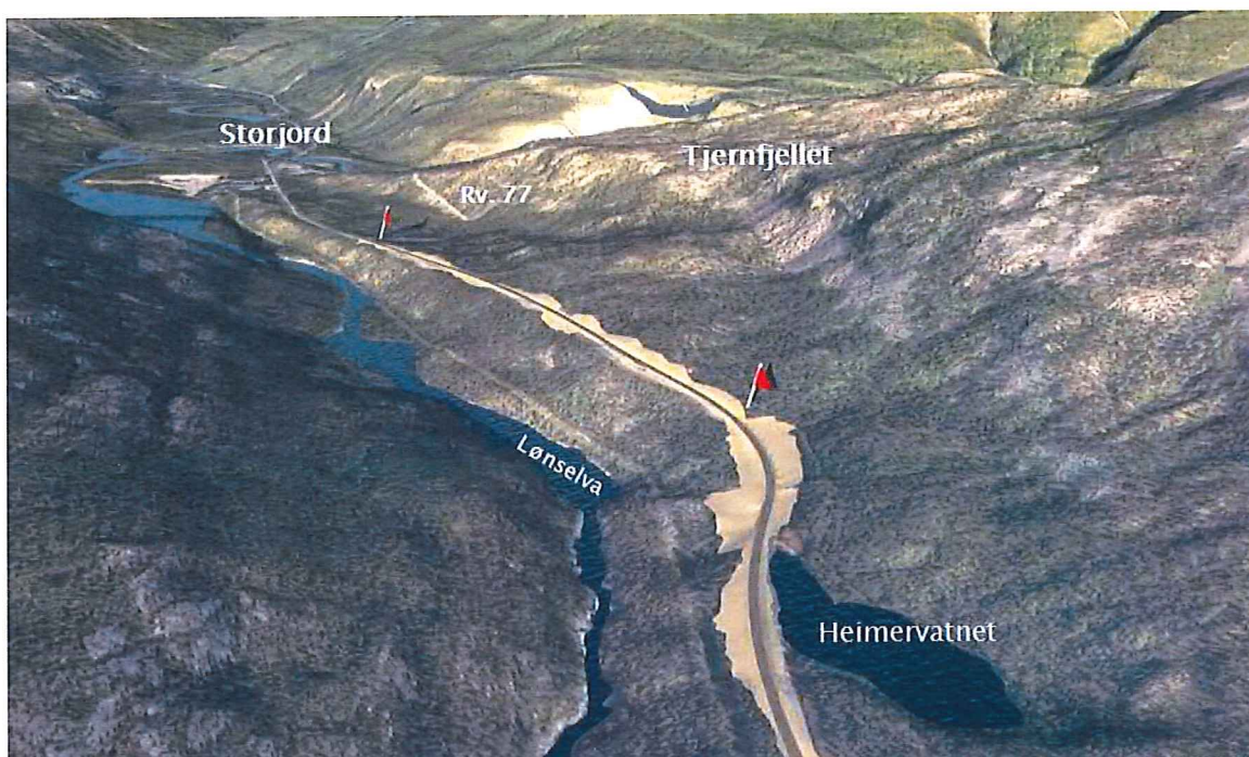
Profil 12 150 – 13 540 (kryss rv. 77). Flaggene markerer den omtalte strekningen. De brede feltene langs vegen viser de foreslåtte deponiene for overskuddsmasser.
